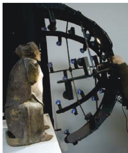
(b) Dispositif d'acquisition des PTMs
