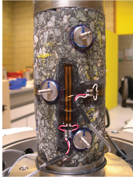
Fig 6.7 – Photo d'une jauge de déformation après l'essai 2 : compression cyclique sinusoïdale à q_{moy}=200 kPa, \sigma_r=100 kPa, f=1 Hz et T=20^\circ C
