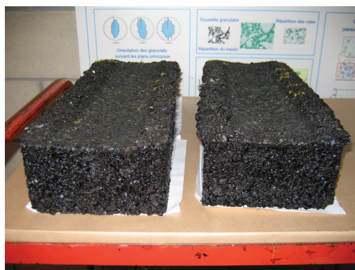
Fig 1.38 – Plaques d'enrobé après l'essai à l'ornièreur
