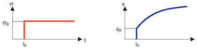
Fig 1.6 – Essai de fluage d'un matériau viscoélastique linéaire
