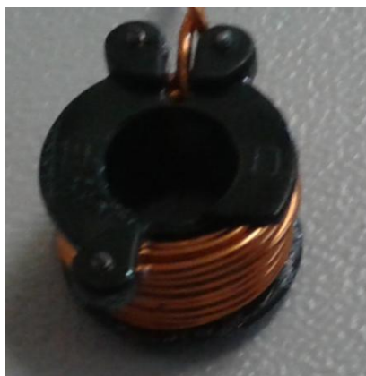
Figure 1.9 – Bobine construite par l'enroulement d'un fil de cuivre.
