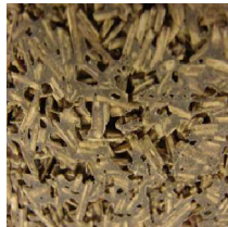
Figure 3.36. Matériau absorbant naturel à base de béton de chanvre [137].
