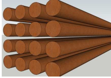
Figure 1.8. Arrangement périodique des diffuseurs (cylindres) dans un cristal sonore.
