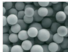
Figure III.23. Image SEM de particules de silice Kromasil [46]
