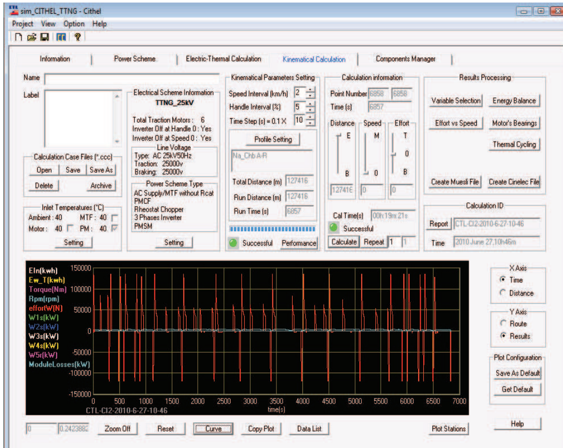
Figure I.7 : exemple de simulation de la ChT du Tram Train sur CITHEL
