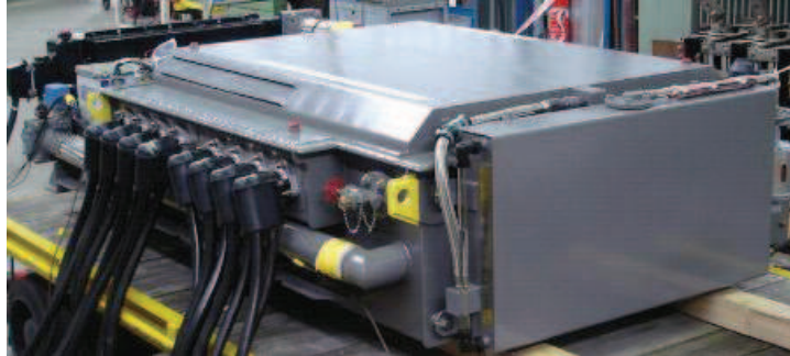
Figure II.2 : Transformateur de traction du Tram Train
