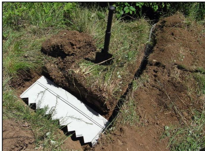
Figure 2.5 : Photo de l'installation d'une plaque lysimétrique.
