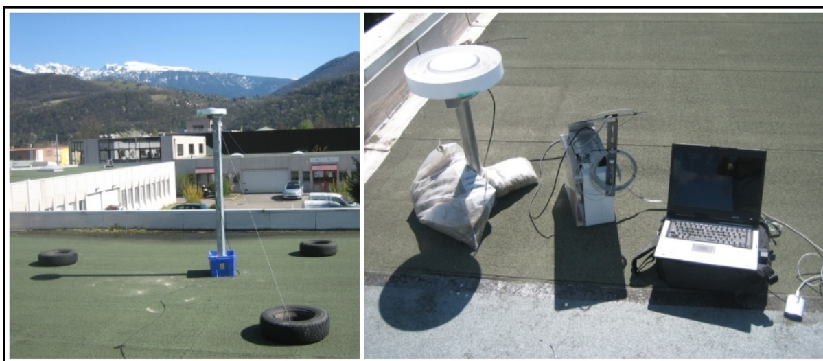
Figure 19 : Instrumentation GPS : Station de référence sur le toit de Myotis (gauche) et station mobile sur le toit du LGIT (droite)
