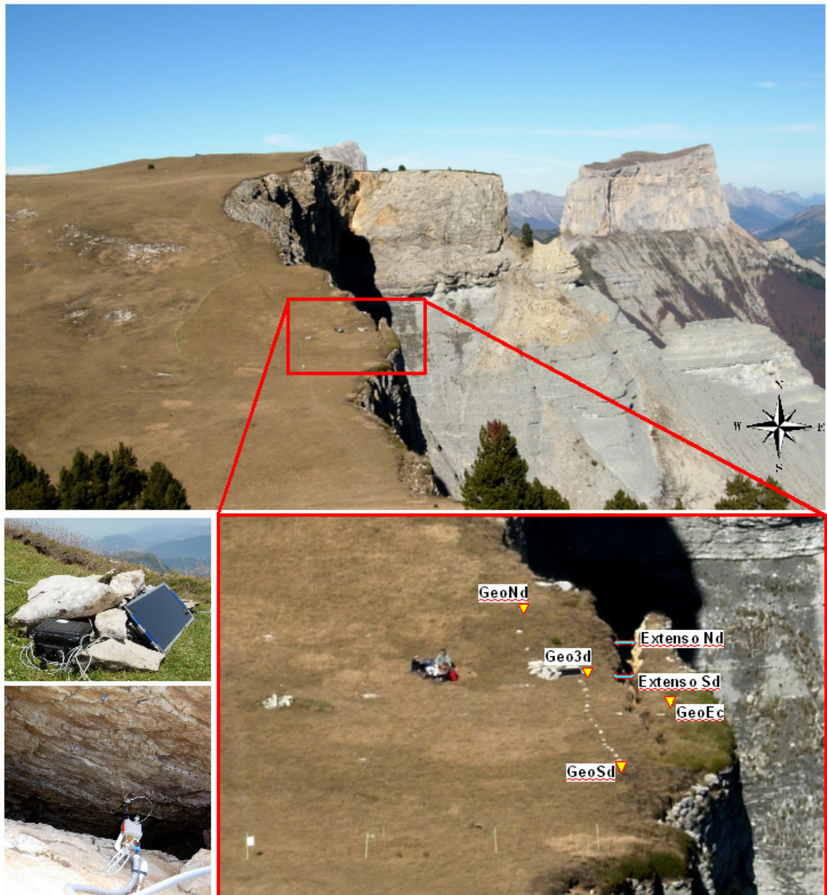
Figure 45 : Localisation et instrumentation de l'écaille de Chamousset (haut) Panorama de l'écaille de Chamousset avec Mont Aiguille, (bas droite) Localisation des capteurs, (bas gauche) Station de mesure avec son panneau solaire et capteur extensométrique (ExtensioNd) situé dans la fracture arrière de l'écaille
