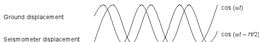
Figure B.1.1 : Déphasage entre déplacement du sol et déplacement de la masse (d'après NMSOP)
