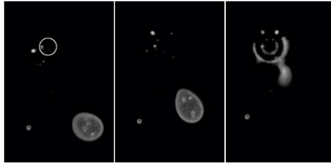
FIGURE 1.19 – Sous une insonification à 40 kHz, une vésicule ( R = 40\mu\text{m} ) avec une membrane lipidique fluorescente est attirée par une bulle oscillante (entourée par un cercle blanc R = 20\mu\text{m} ). La vésicule se déforme et fragmente. Temps de 1 s entre les clichés. Adapté de [MH03].
