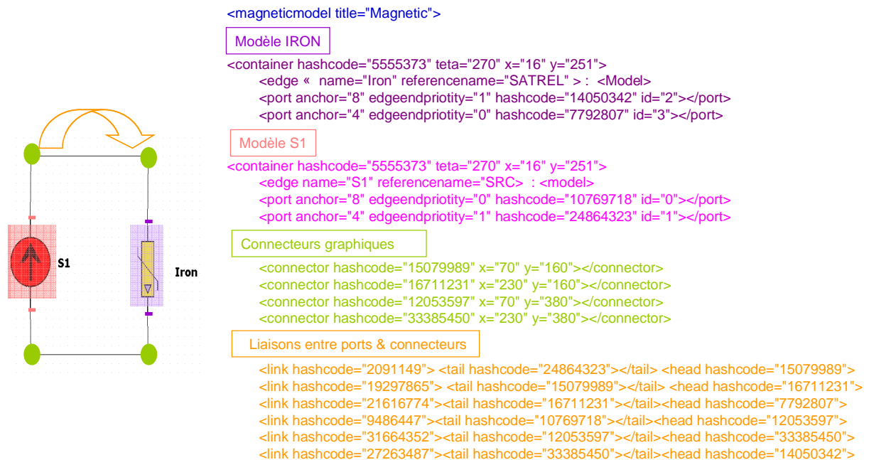
Figure 4-16 : Description existante d'un circuit magnétique dans RelucTool
