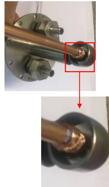
Figure 54 Fixation des sondes sur le tube de prise de pression de pression
