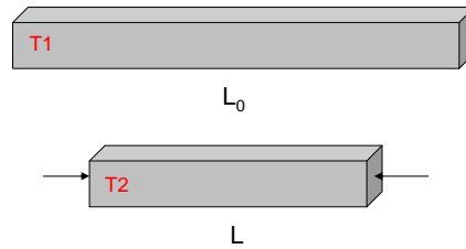
FIGURE 1.17 – Dilatation thermique d'un barreau refroidi.
