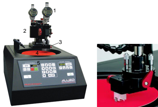
(a) 1 = mesureur différentiel, 2 = Potence, 3 = Porte échantillons, 4 = disque rotatif, 5 = pavé et contrôleur numériques
