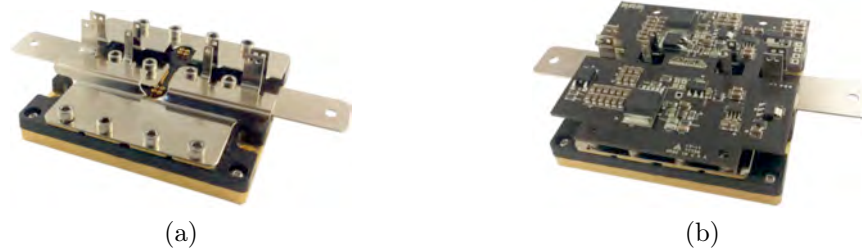
FIGURE 1.39 – Détails du module HT-2000 de la société APEI, connectiques de puissance et carte driver
