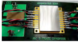
FIGURE 1.37 – Onduleur haute température composé de JFET [BUT 11]
