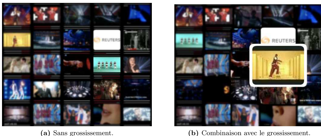
Figure 3.4. Augmentation de la saillance par la netteté sous le curseur avec une présentation de documents vidéos comme celle du mur de BlinkX.
