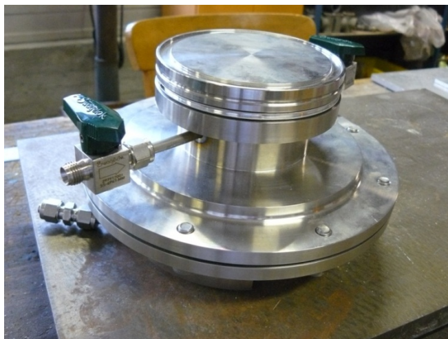
Photographie de la cellule utilisée pour la saturation des échantillons de Callovo-Oxfordien sous atmosphère inerte avec P_{N_2} \approx 2 bar
