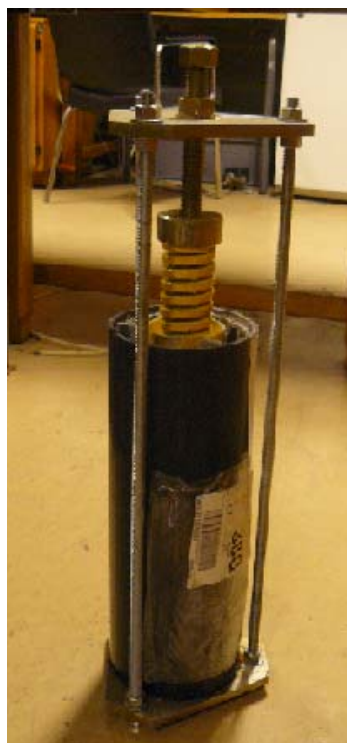
Cellule de transport T1 pour les carottes d'argilite du Callovo-Oxfordien
