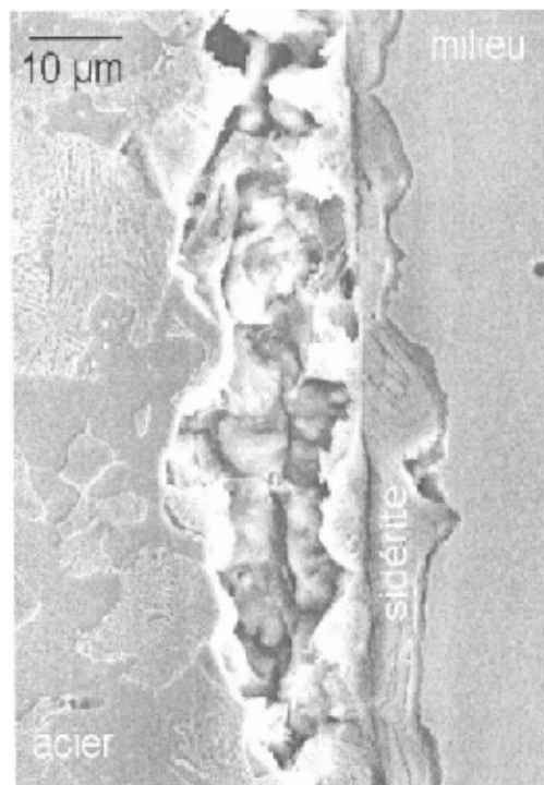
Figure 9 : Micrographie en coupe d'un échantillon d'acier XC38 après corrosion anaérobie à 90°C pendant 328h en présence d'une argile FoCa7 et d'une eau de site granitique (Bataillon et al., 2001)
