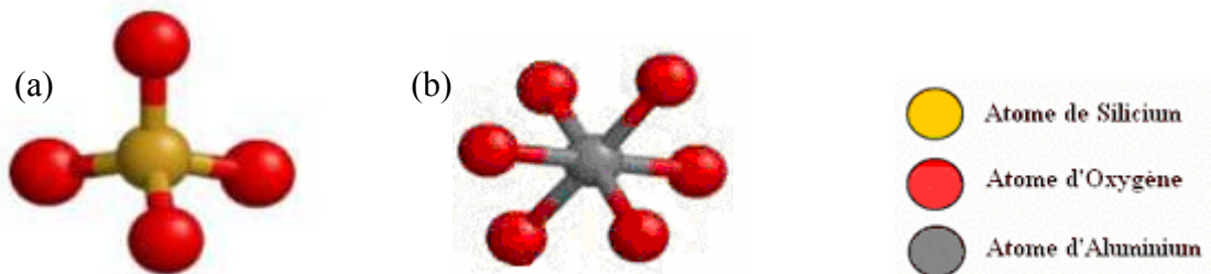
Figure 3 : Structure minérale de base des argiles (a) Structure tétraédrique (b) Structure octaédrique
