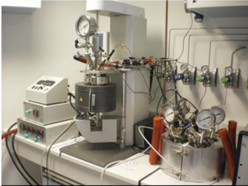
Figure 26 : Banc expérimental pour les essais de réactivité de H_2(g) avec des matériaux argileux, muni d'un réacteur d'1L en titane (à gauche) et d'un ensemble de 4 réacteurs de 300 mL en acier inoxydable (à droite). L'ensemble de ces réacteurs sont reliés à un chromatographe en phase gazeuse via un système automatique de vannes.
