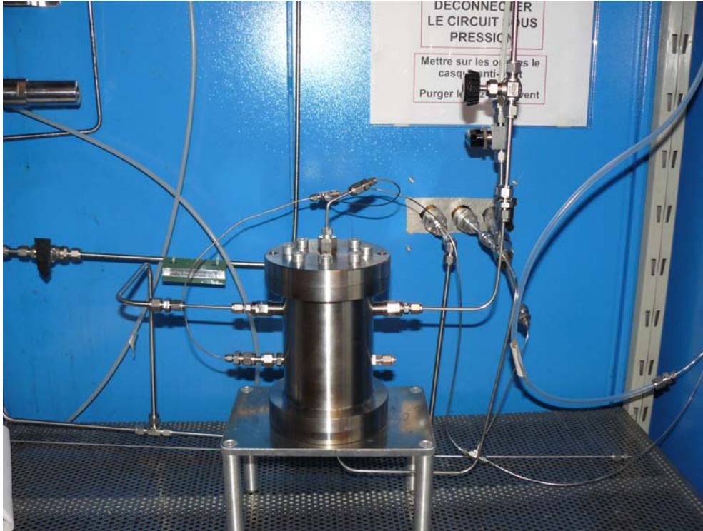
Photographie du montage expérimental pour la mesure de pression résiduelle avec la cellule triaxiale placée au centre
