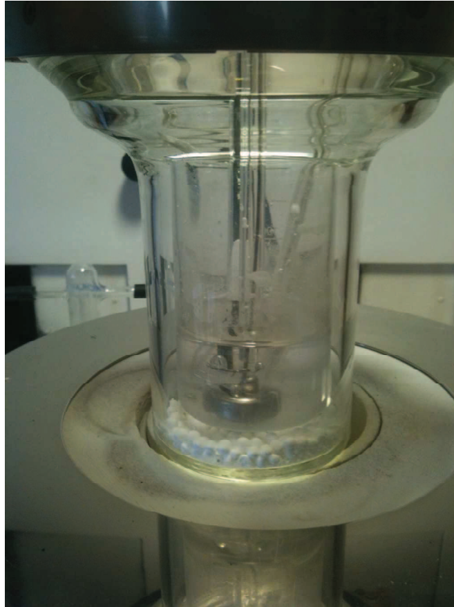
Figure B.4 : Electrode de bismuth liquide. Nacelle plongée dans un sel LiC-LiF fondu
