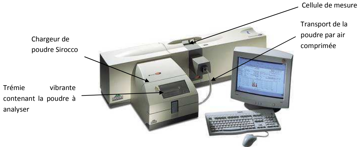
Figure II-2 : Granulomètre laser pour l'analyse de poudre sèche.
