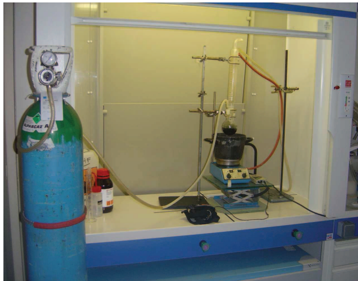
Figure 2.1: Le montage utilisé pour la synthèse de nanoparticule par décomposition thermique ou micelles inverses.
