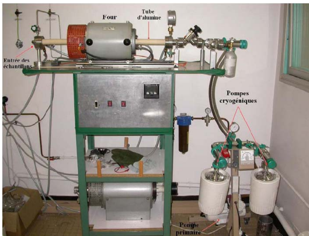
Fig. 2.4 Image du four d'oxydation sous ^{18}\text{O}_2 au sein du LEMHE/ICMMO
