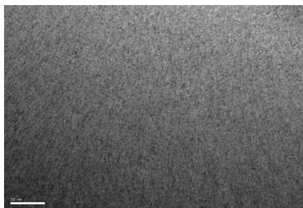
Fig. A4.4 Microstructure du substrat interne de Zr_{55}Cu_{30}Al_{10}Ni_5 oxydé à 648 K pendant 1,5 h
