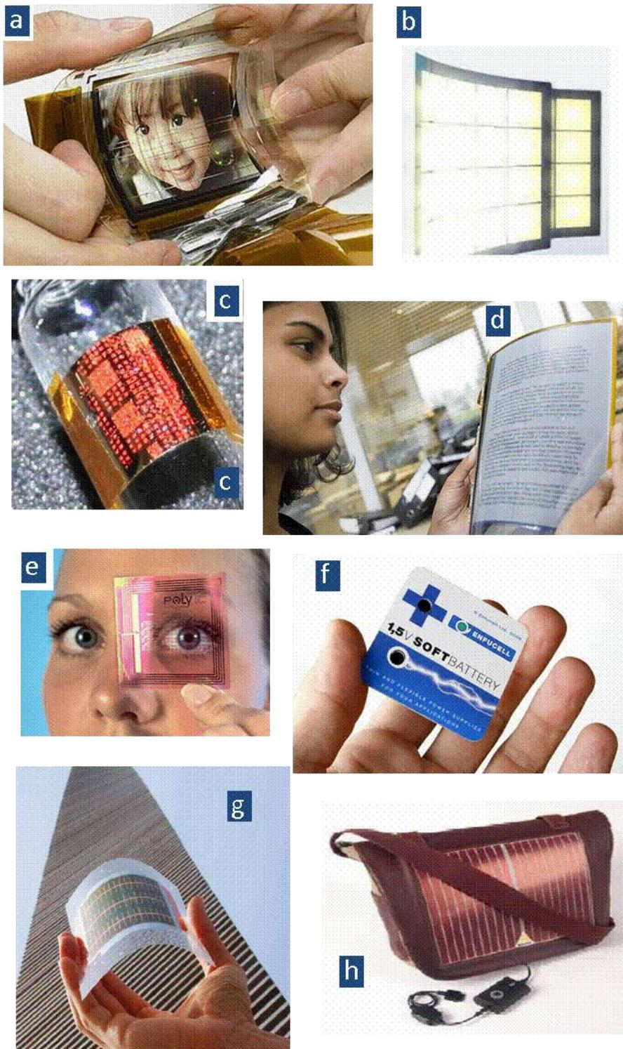
**Fig. 1-2.** Exemples de dispositif de l'électronique organique : (a) afficheur flexible à OLED ; (b) Luminaire à OLED [Philips]; (c) étiquettes et packaging intelligent ; (d) e-paper [LG flexible e-paper displays] ; (e) étiquette RFID [Poly-IC] ; (f) batterie organique ultra fine [enfuCELL softvattery] ; (g) et (h) modules photovoltaïques organiques pour intégration au bâtiment et applications embarquées respectivement [Konarka Power Plastics]
