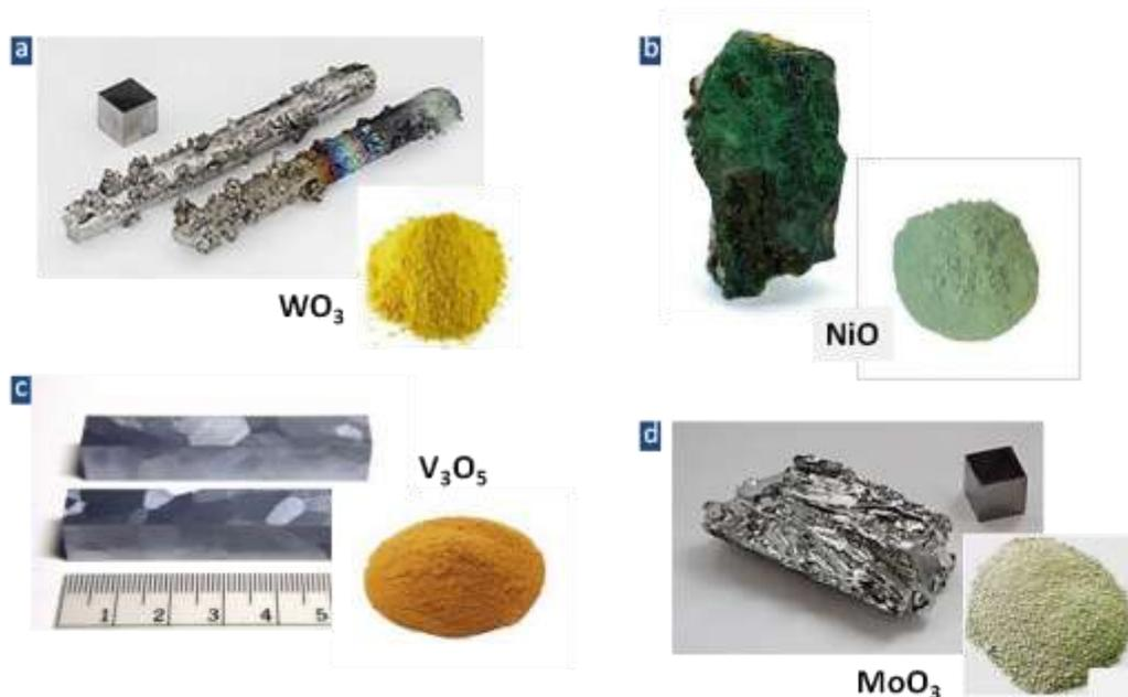
Fig. 2-14. Représentation des quatre principaux matériaux semi-conducteurs de type-p employés dans le photovoltaïque organique sous leurs formes brute et oxydée : (a)  $\text{WO}_3$ ; (b)  $\text{NiO}$ ; (c)  $\text{V}_2\text{O}_5$ ; (d)  $\text{MoO}_3$ .
