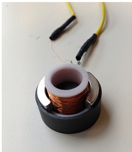
Figure 5.14 – Photo du prototype 2, comprenant deux aimants de 4 mm de haut.
