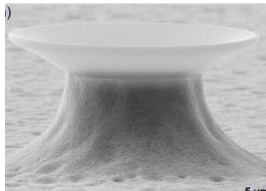
Figure 1-6: Microcône en PMMA de 40\mu\text{m} de diamètre sur substrat silicium [27]
