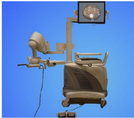
Figure 10 : Le système ARTEMIS avec sonde reliée à un bras mécanique
