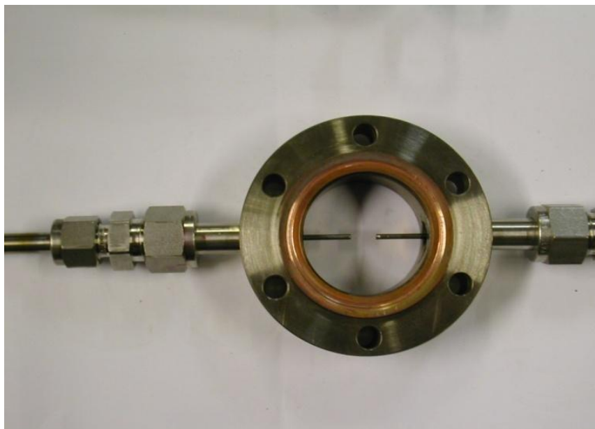
Figure 5 : Photographie des injecteurs montés transversalement à l'écoulement et utilisés pour introduire le gaz précurseur en son cœur.
