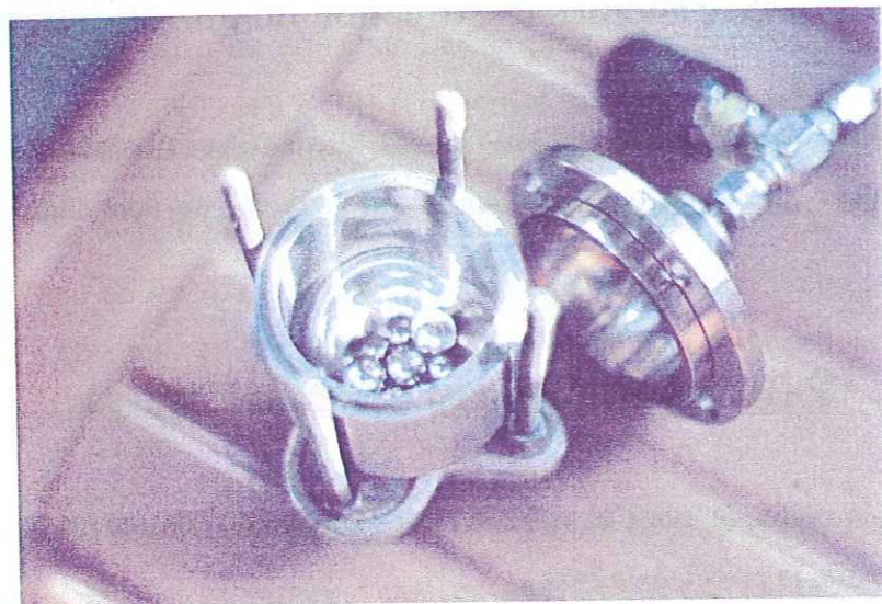
Figure III.2- Gamelle, porte-échantillon de glace pour l'analyse du CO 2
