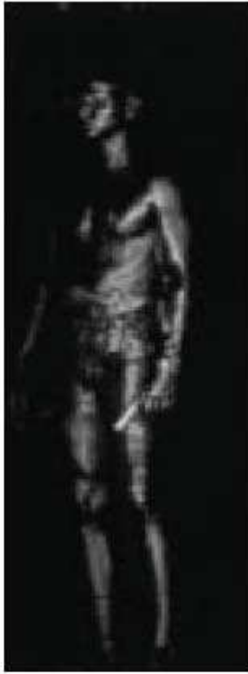
FIG. 1.6 – Image obtenue avec le portique 3D développé par PNNL Image holographique d'un mannequin obtenue avec le portique fonctionnant entre 27-33 GHz développé par PNNL. Le mannequin porte des objets sous ses vêtements et une arme à la main.
