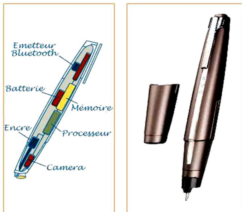
Illustration 7 : Schéma et photo d'un stylo numérique
