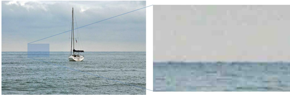
Figure 2.17 – Illustration de l'effet de bloc. On voit bien l'apparition des frontières entre blocs au niveau de la mer ou du bateau comme illustré sur le zoom de l'image. [FR07]
