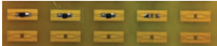
Figure III-19 – Circuit de test pour la diode varicap
