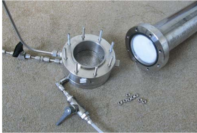
Figure 7.4. Photographie du deuxième bloc (à gauche posé sur le premier bloc) et troisième bloc (colonne à droite) constituant le réservoir. Le piston et le joint torique y sont visibles.
