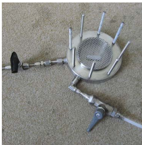
Figure 7.3. Photographie du premier bloc constituant la base du réservoir.
