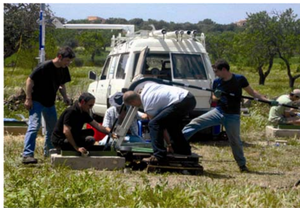
Figure 4.7. Photo de l'installation du stringer de résistivité électrique dans les puits MC9 (mai 2005, site expérimental de Ses Sitjoles)
