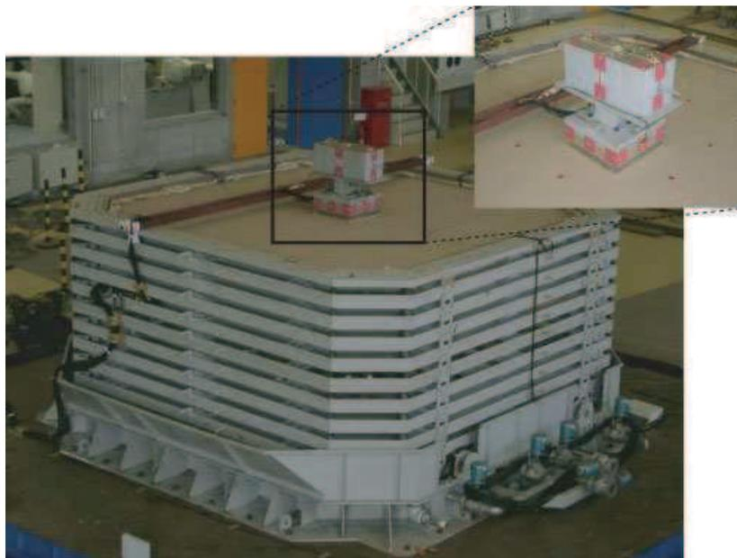
FIG. 2.18 – Dispositifs expérimentaux sur la table vibrante avec le modèle ([Paolucci et al., 2008]).
