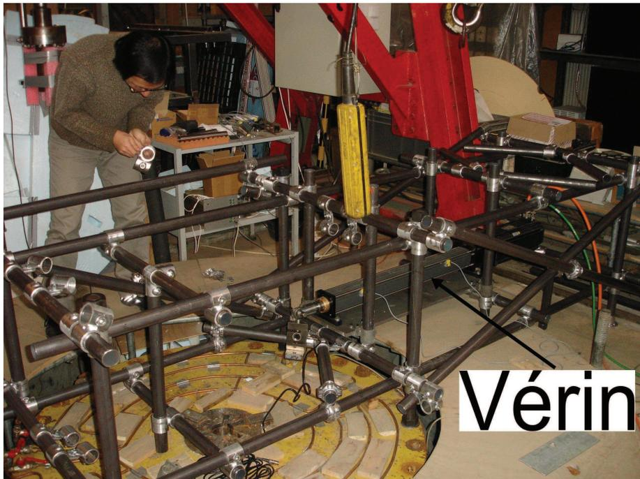
FIG. 3.10 – Photo du bâti de réaction
