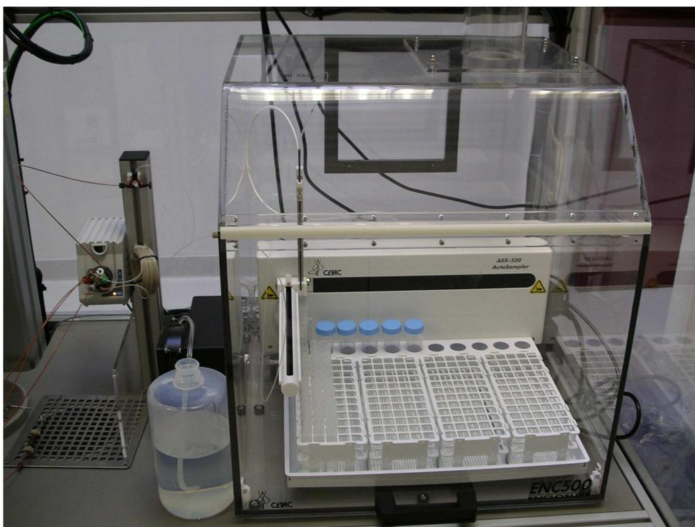
Figure II-7 : Photographie du circuit d'échantillonnage (sans la pompe de chromatographie)
