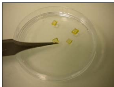
Figure 128 : photographie des granulés du PLGA utilisé. Chaque granulé pèse 15mg.
