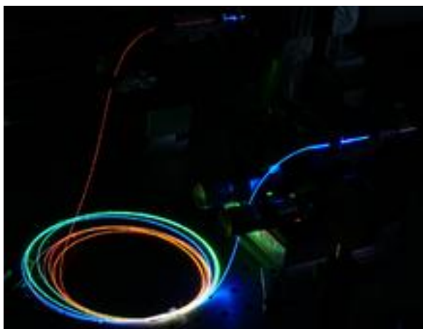
Figure 12 : Supercontinuum formé dans une fibre optique microstructurée grâce à des effets non linéaires.
