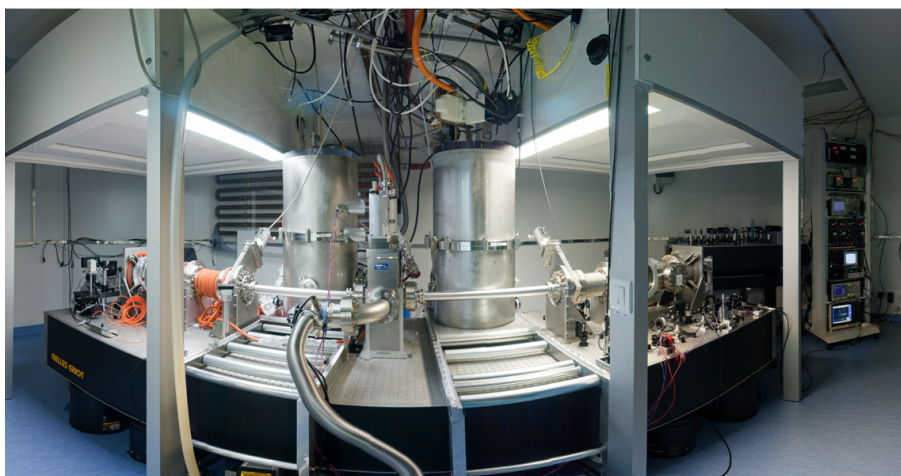
FIGURE 2.15 – Photographie de la salle blanche dans laquelle est montée l'expérience BMV. On visualise les deux cryostats (placés ici en retrait de la cavité optique) et les deux caissons soufflants. Cette salle blanche a pour objectif de protéger les miroirs de la cavité de toute poussière.
