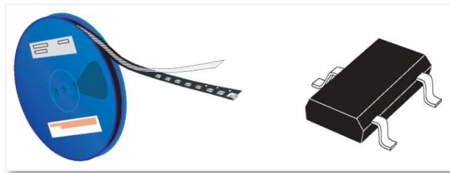
Figure 42 - A gauche : Bobine Tape & Reel 71 . A droite : semi-conducteur de type SOT23-3 72 .
