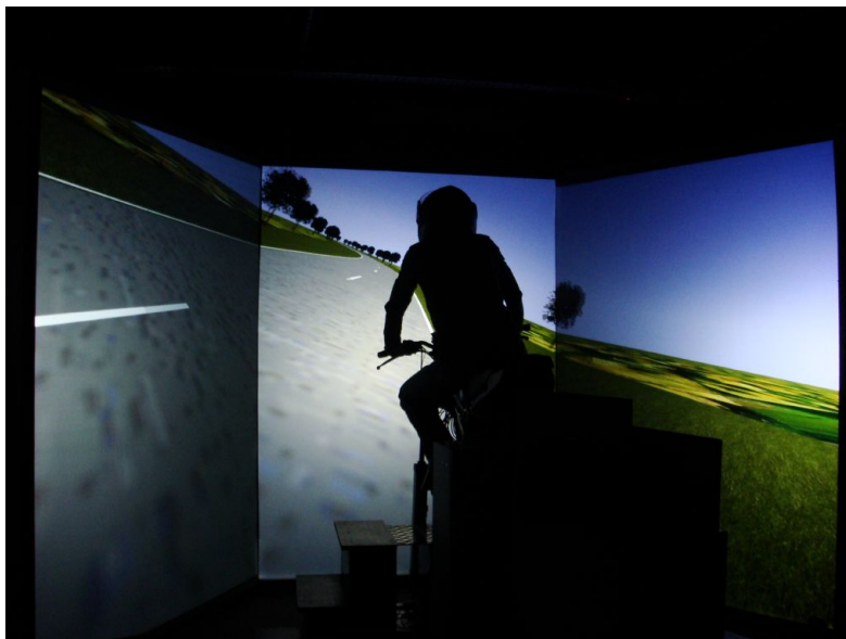
FIGURE 13.4 – Motocycliste en position de conduite sur le simulateur IFSTTAR et faisant face à l'image projetée sur trois écrans. L'inclinaison de la scène visuelle est dans la direction opposée à celle du simulateur.
