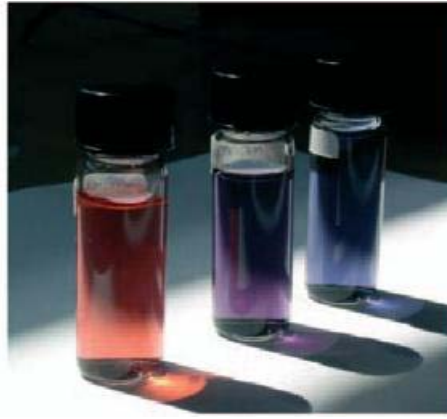
FIGURE 1.7 – Couleur de l’or à l’échelle du nanomètre : en rouge à gauche, solution contenant des nanoparticules d’or sphériques de 15 nm de diamètre; en violet solution identique mais contenant des particules agglomérées entre elles; et en bleu solution contenant des nanobâtonnets d’or de 5 nm [31]
