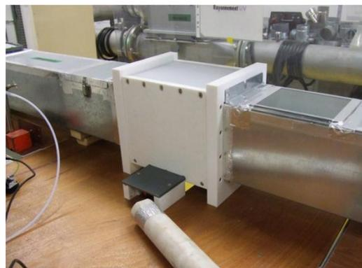
Figure 6-2 : Réacteur plasma froid EDF R&D et aperçu de son positionnement dans la boucle d'essais
