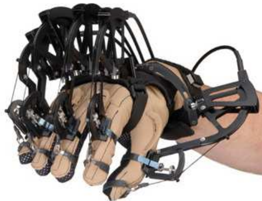
FIGURE 1.6 – Exo-squelette appliquant un retour d'effort sur la main (photo © CyberGlove Systems).
