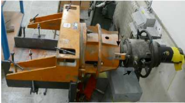
Figure III-31 Photo du dispositif d'essai à simple recouvrement (a) et illustration d'un essai de cisaillement réalisé sur un des joints collés à simple recouvrement (b).
