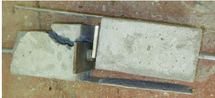
Figure III-8 Rupture en coin lors d'un essai à double recouvrement.
