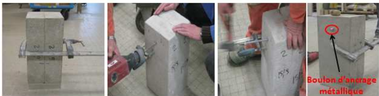
Figure III-18 Assemblage des demi-blocs de béton pour obtenir un seul bloc solide.
