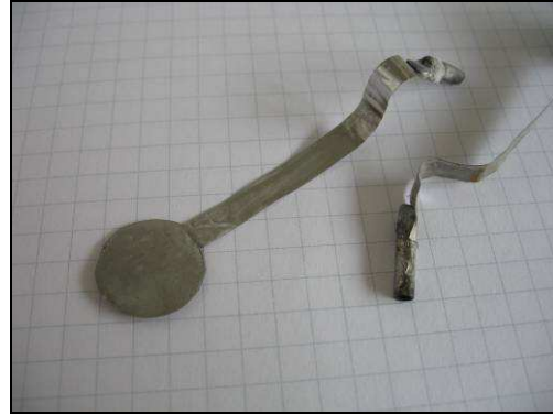
Figure II.9 – Photographies des collecteurs et des éléments d'une cellule de test
