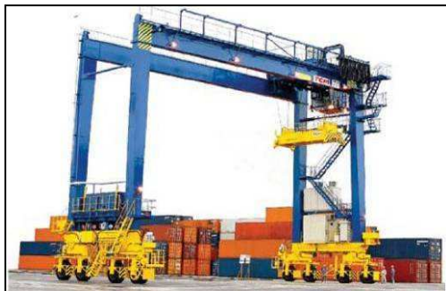
Figure I.6 – Grue portuaire japonaise équipée de supercondensateurs
