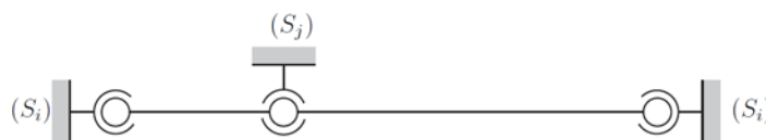
Figure 2.55. Modélisation des liaisons entre les axes ( S_i ) et ( S_j ) et la vis à billes ( V_{ij} )
