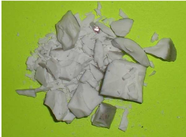
*Figure 49 : Photographie d'un plot d'alumine de référence h15 après un essai de traction indirect*
