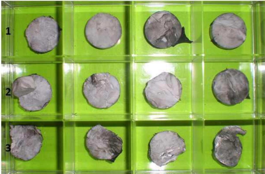
*Figure 57 : Faciès de rupture de nodules éjectés des cibles SPS h15/4 après essai balistique*
