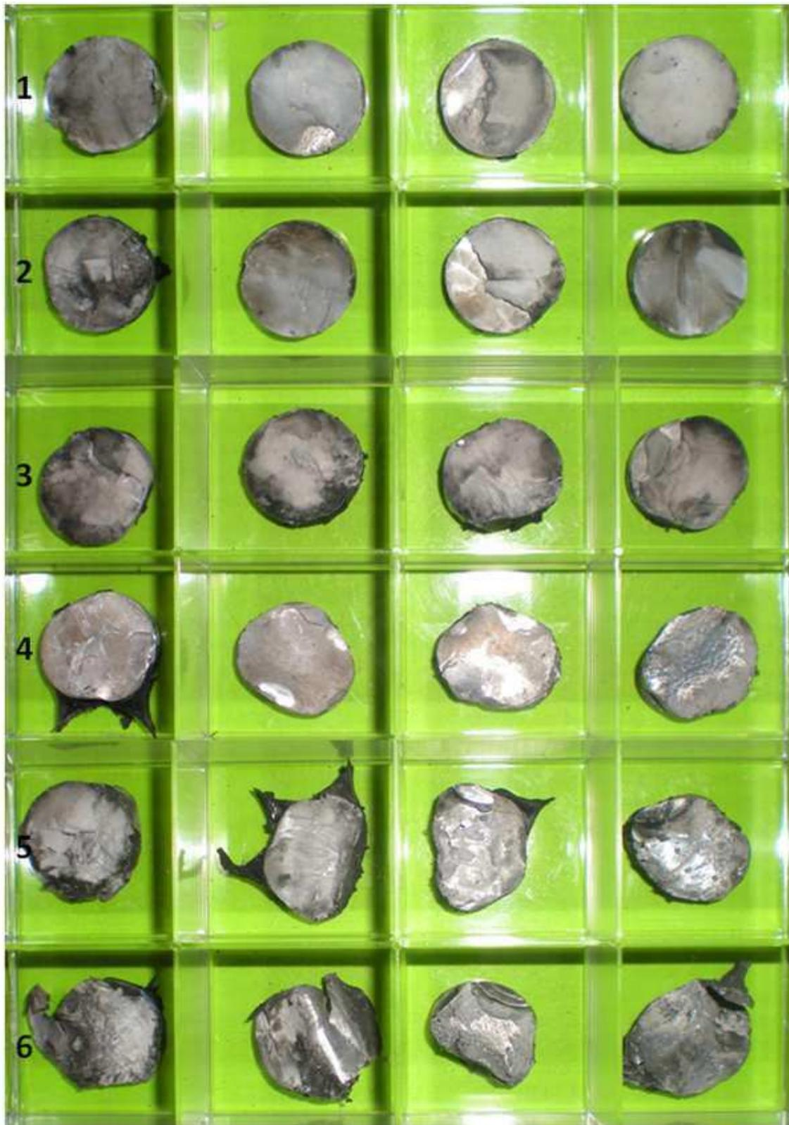
*Figure 56 : Faciès de rupture de nodules sortis des cibles CERAMET après essai balistique*
