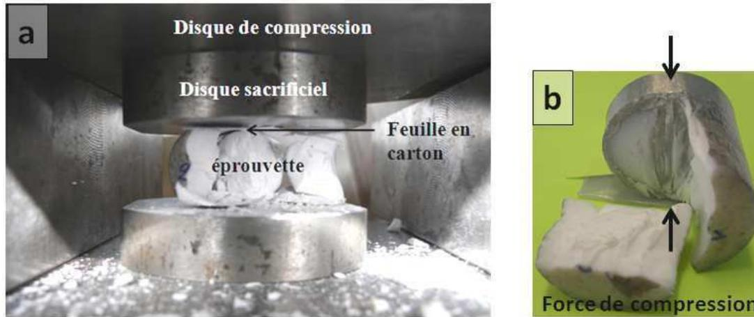
Figure 47 : Photographie d'une éprouvette en cours (a) et après l'essai brésilien (b)
