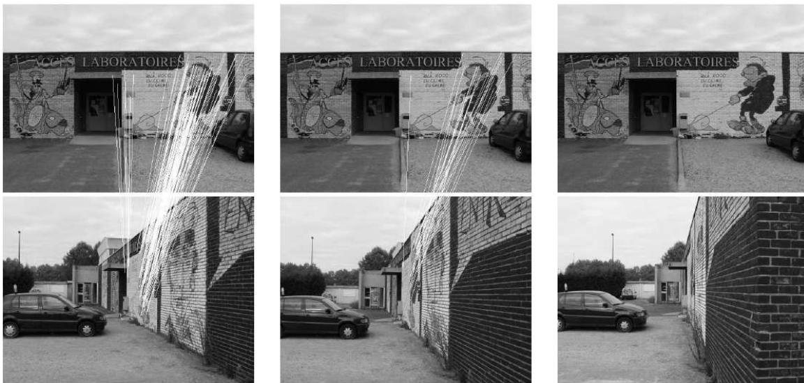
FIG. 2.12 – Illustration de la robustesse aux transformations affines du détecteur ASIFT. Source : [Yu et Morel, 2009].
