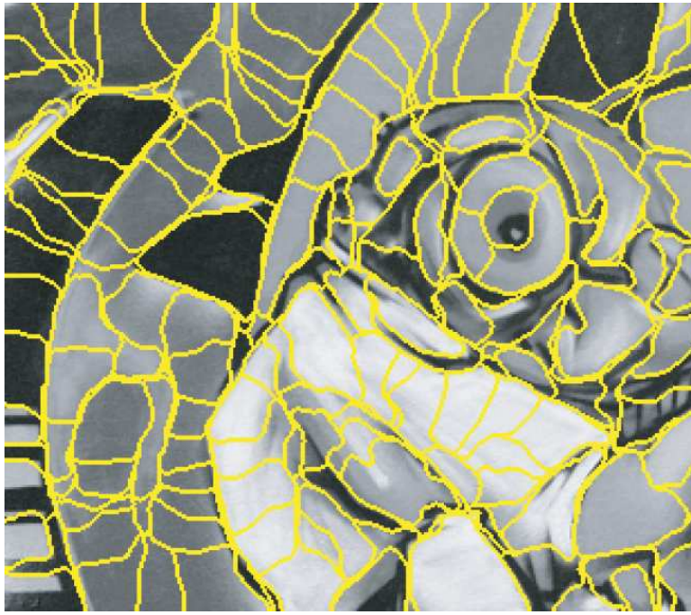
FIG. 2.11 – Illustration de la segmentation d'une image en superpixels. Source : [Ren et Malik, 2003], [Mori et al. , 2004].
