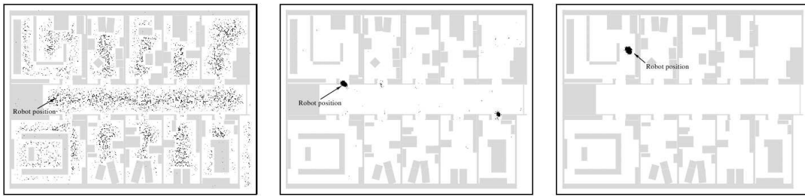
FIG. 1.5 – Illustration de la convergence du processus de localisation globale MCL : au départ, les particules sont dispersées sur toute la carte, avant de se concentrer au fur et à mesure des déplacements et des observations sur la position réelle. Source : [Dellaert et al. , 1999].
