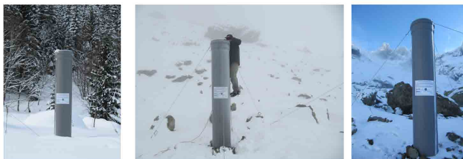
FIG. 3.15: Totalisateurs en place sur le Vorz
