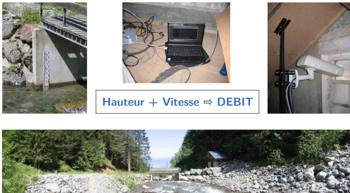
FIG. 3.22: mesure du débit par le capteur IMAGE
