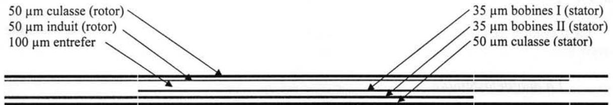
Fig. 3.9.3.2 Modèle 2D d'un moteur diphasé (1/2 du moteur).
