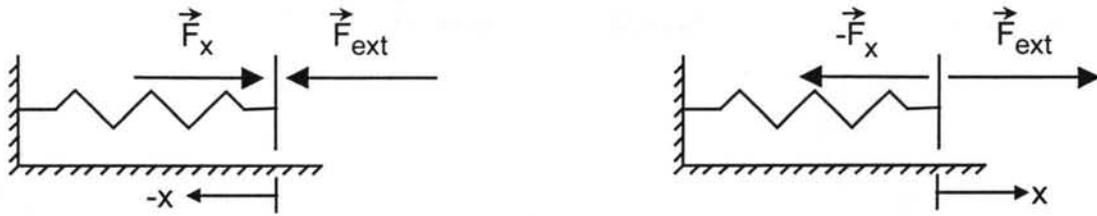
Figure 2.4.2.1 Forces et raideurs dans un ressort
