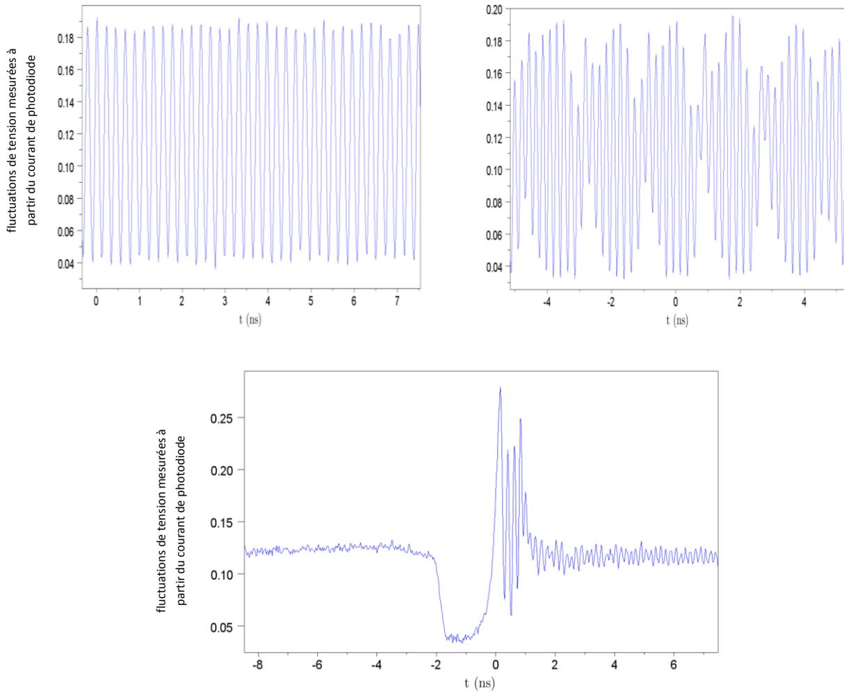
Figure 4-25 : Fluctuations temporelles de la tension mesurée à partir du courant de photodiode pour la diode réinjectée à un courant d'injection  $I=33.94$  mA : le signal est instable et passe aléatoirement d'une forme à une autre
