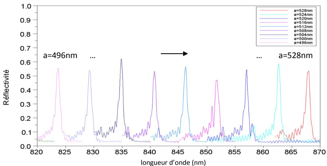
Figure 3-37 : spectres de réflectivité des gros réseaux (101 périodes) mesurés avec le spot adapté sur l'échantillon FBINE24 pour des pas compris entre 496 nm et 528 nm (de gauche à droite : de 496 nm à 528 nm, par pas de 4 nm)
