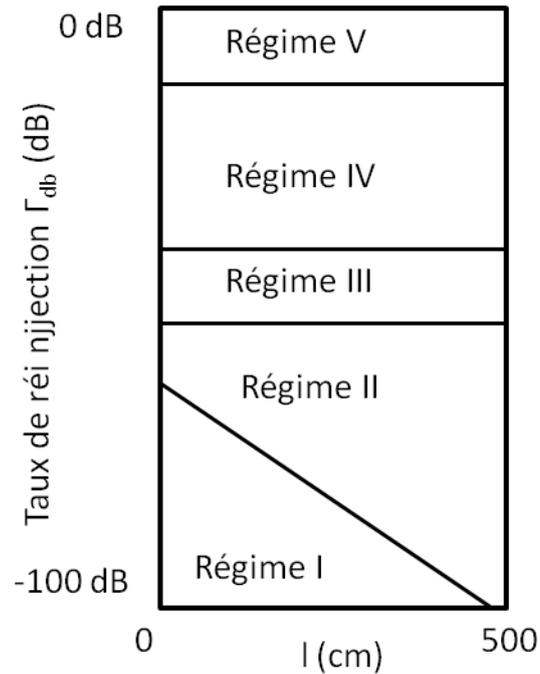
Figure 1-3 : les différents régimes de réinjection en fonction du taux de réinjection et de la longueur de cavité externe
