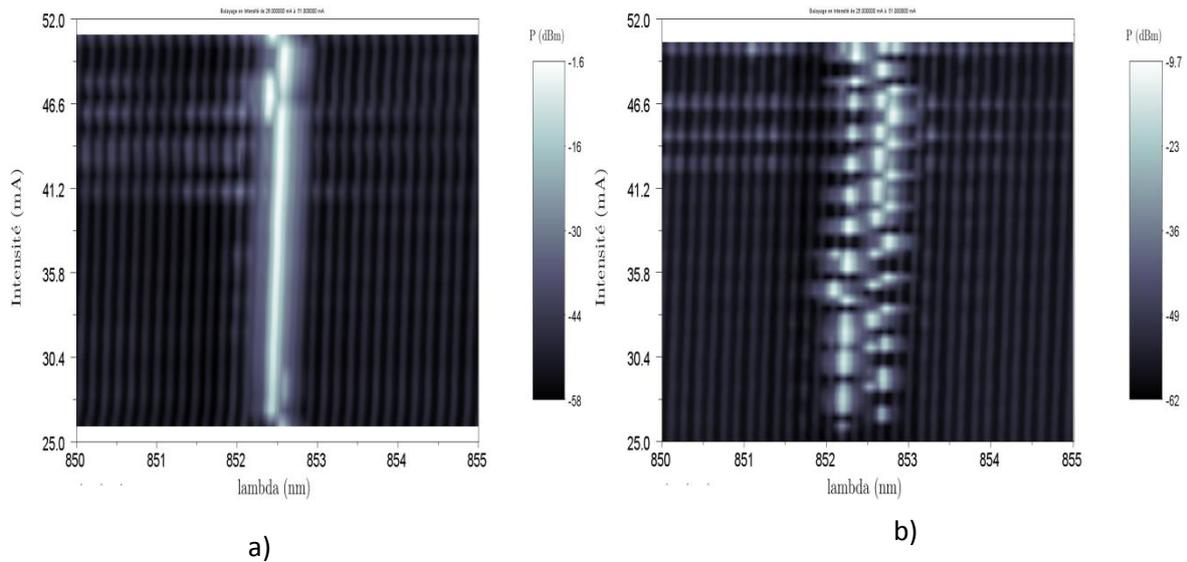
**Figure 4-18 : Cartographies du spectre optique de la diode stabilisée à T=35°C dans deux situations : a) : situation optimisée pour laquelle  $l=m.l_0$  et b) : situation de désaccord entre les deux cavités**
