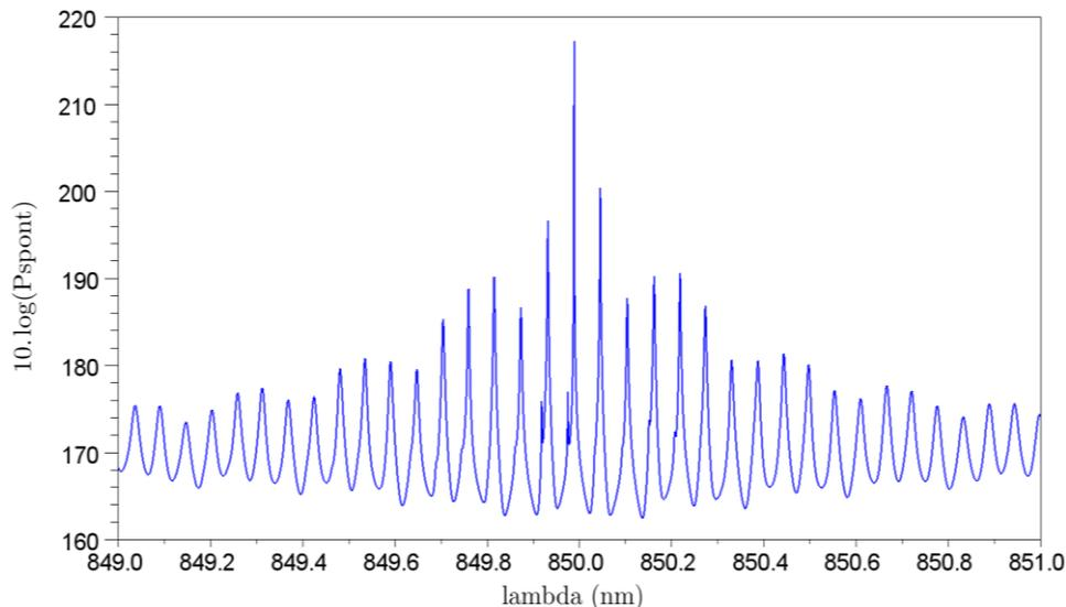
**Figure 2-20 : Spectre d'émission spontanée calculé pour un réseau de 0.4 nm de large, un laser de longueur 400  $\mu\text{m}$  des valeurs de réflectivité de 0.05 pour la facette droite du laser et 0.3 pour le filtre et une cavité externe de 5 mm (design 2)**
