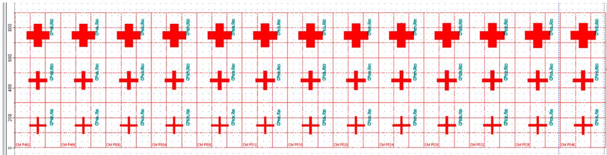
**Figure 3-40 : Masque utilisé sur l'échantillon FBINE 22. Réseaux 2D de 21, 41 et 101 périodes, 80  $\mu\text{m}$  de large. Pas des réseaux : 492, 496, 500, 504, 508, 512, 516, 520, 524, 528, 532, 536, 540 nm. Offset de phase  $1.05a$**
