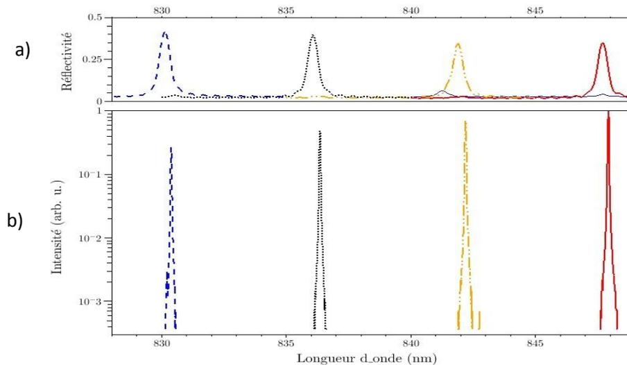
**Figure 4-30 : a) : Spectres des réseaux résonants CRIGF utilisés (réseaux 2D de taille moyenne) et b) : spectres de la diode Eagleyard réinjectée par ces deux réseaux à une température de 20°C et un courant injecté  $I=30$  mA**
