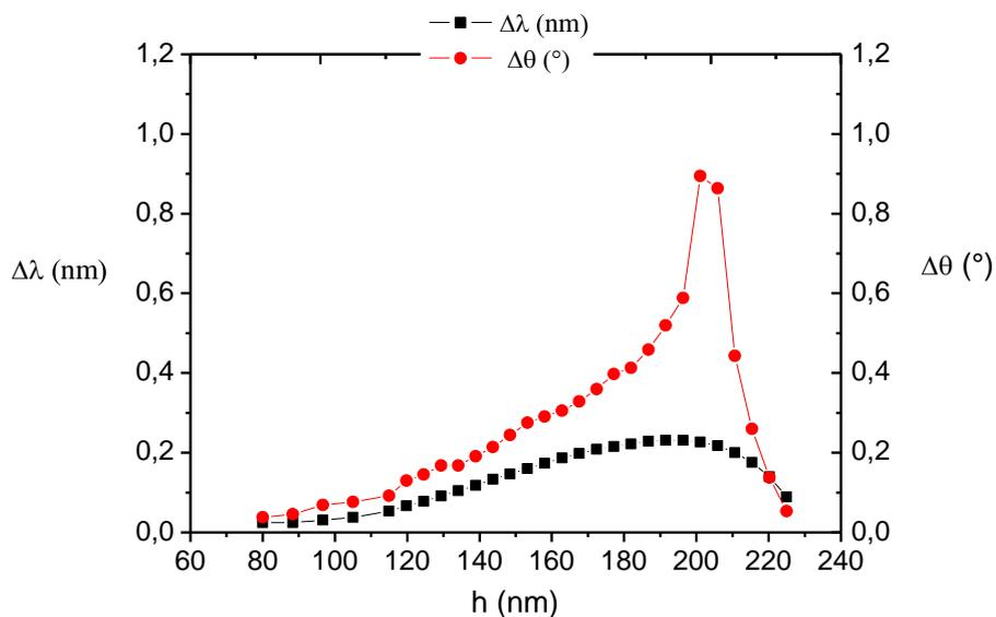
Figure 3-6 : Evolution de la largeur spectrale et de la tolérance angulaire en fonction de la profondeur de gravure pour un réseau à deux atomes par maille
