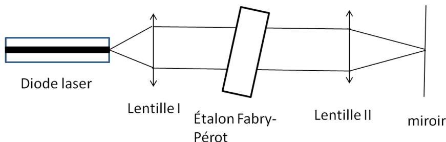
Figure 1-8 : schéma du montage type « œil de chat »
