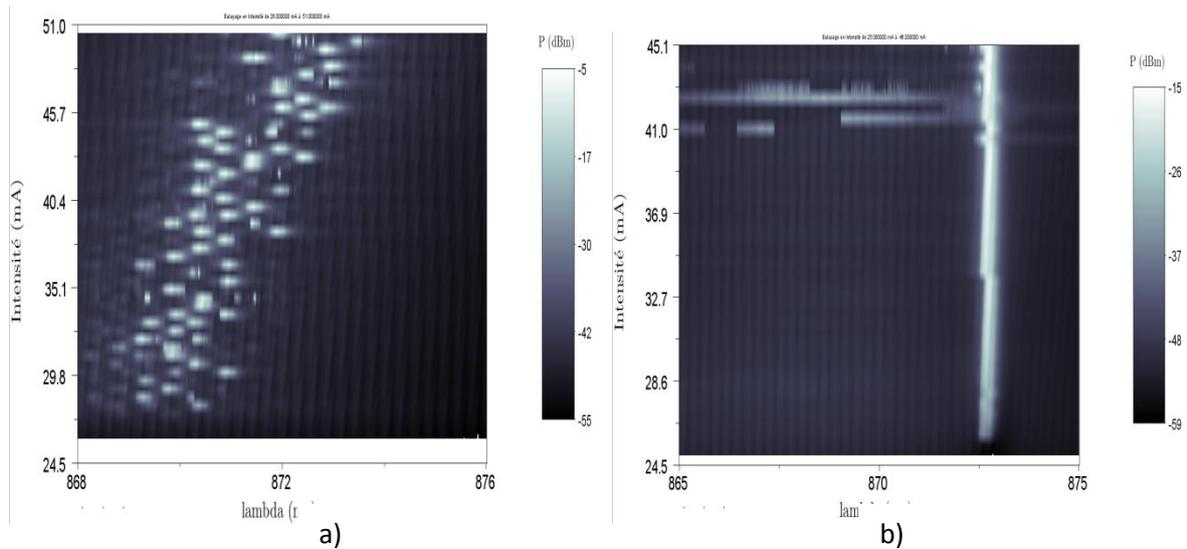
**Figure 4-9 : Cartographie du spectre optique d’une source laser fabriquée au LAAS en fonction du courant injecté dans deux situations : a) : sans réinjection et b) : avec réinjection du réseau résonant**
