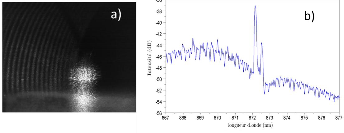
Figure 4-8 : a) : Observation du faisceau quand l'effet laser apparait. b) : Spectre mesuré juste au-dessus du seuil quand le réglage est achevé
