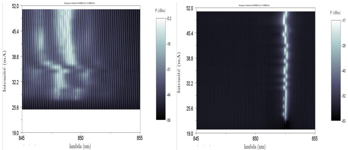
Figure 4-10 : Cartographie du spectre optique d'une source laser Thalès en fonction du courant injecté dans deux situations : a) : sans réinjection et b) : avec réinjection du réseau résonant
