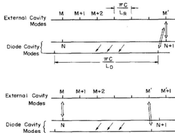
Figure 4-17 : d'après [68], relation entre les modes de cavité laser et les modes de cavité externe quand  $l = m \cdot l_d$  (en haut) et quand  $l$  n'est pas proche d'un multiple entier de  $l_d$  (en bas). Les flèches représentent le glissement vers le bas de la position en fréquence des modes quand le courant augmente.
