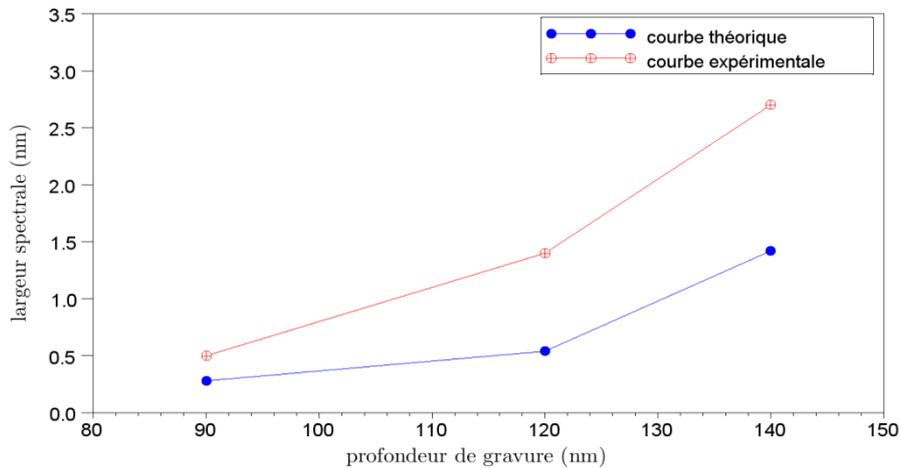
Figure 3-39 : évolution de la largeur spectrale en fonction de la profondeur de gravure pour un réseau de pas  $a=528$  nm, largeur de lignes  $D=100$  nm,  $\delta=1.05.a$ , DBR de 200 périodes (simulations issues du paragraphe 3.2.c.v)
