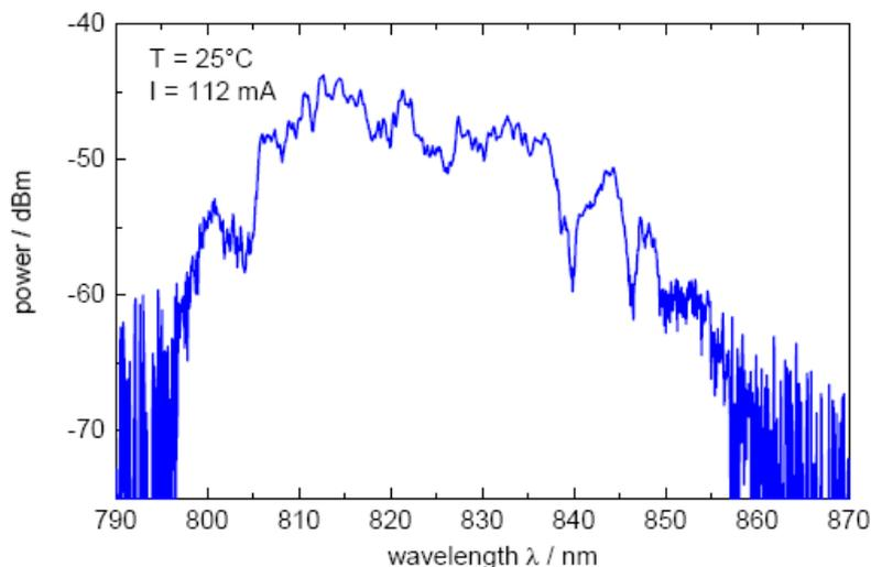
Figure 4-26 : spectre typique d'une diode laser Eagleyard sans réinjection externe d'après la documentation Eagleyard
