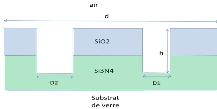
Figure 3-5 : Schéma d'une période du réseau à deux atomes par maille
