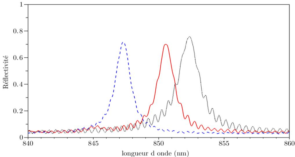
**Figure 3-30 : spectres expérimentaux pour les 3 tailles de réseau avec le spot optimal (courbe bleue en traits longs: petit réseau de 21a, avec la lentille de focale 25 mm, courbe rouge continue : moyen réseau de 41a, avec la lentille de focale 40 mm, courbe noire pointillée : gros réseau de 101a, avec la lentille de focale 75 mm)**
