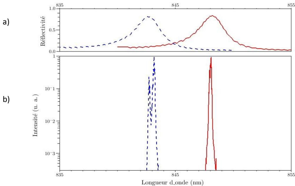
**Figure 4-29 : a) : Spectres des deux réseaux résonants CRIGF utilisés (réseaux de 21 périodes) et b) : spectres de la diode Eaglyard réinjectée par ces deux réseaux à une température de 20°C et un courant injecté I=30 mA**
