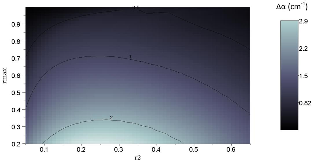
Figure 2-12: Cartographie de  $\Delta\alpha$  en fonction de la réflectivité de la facette  $r_2$  du laser et de la réflectivité maximale du filtre, avec une largeur spectrale  $\Delta\lambda=1$  nm et une longueur de cavité laser  $l=300$   $\mu\text{m}$
