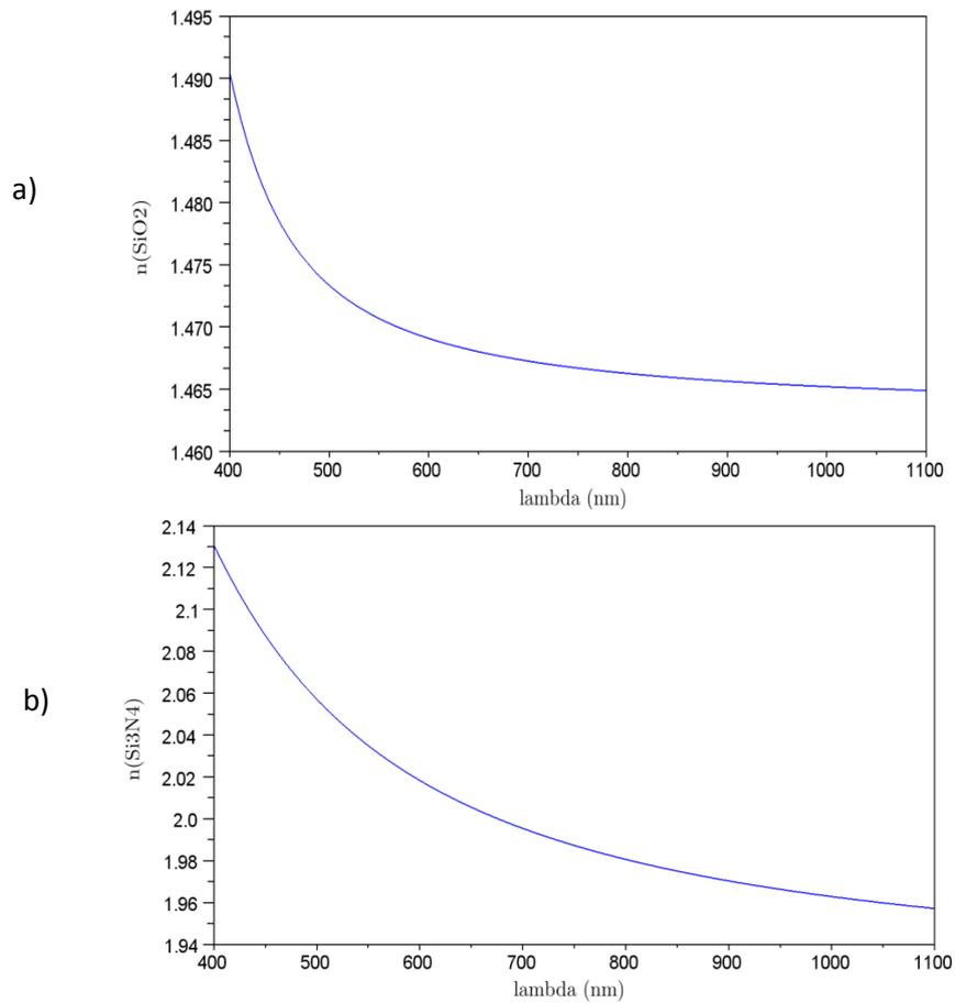
Figure 3-15 : a) : dispersion d'indice du SiO<sub>2</sub> b) : dispersion du Si<sub>3</sub>N<sub>4</sub>, mesurées à l'ellipsomètre
