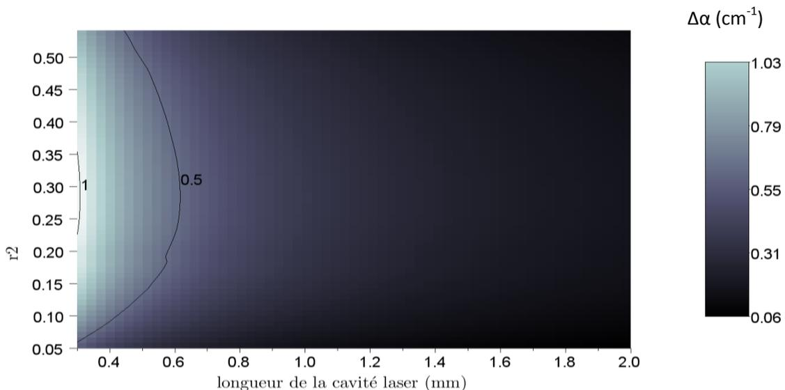
Figure 2-11: Cartographie de  $\Delta\alpha$  en fonction de la réflectivité de la facette  $r_2$  du laser et de la longueur de la cavité laser, avec  $r_{\max}=0.5$  et une largeur spectrale  $\Delta\lambda=1$  nm
