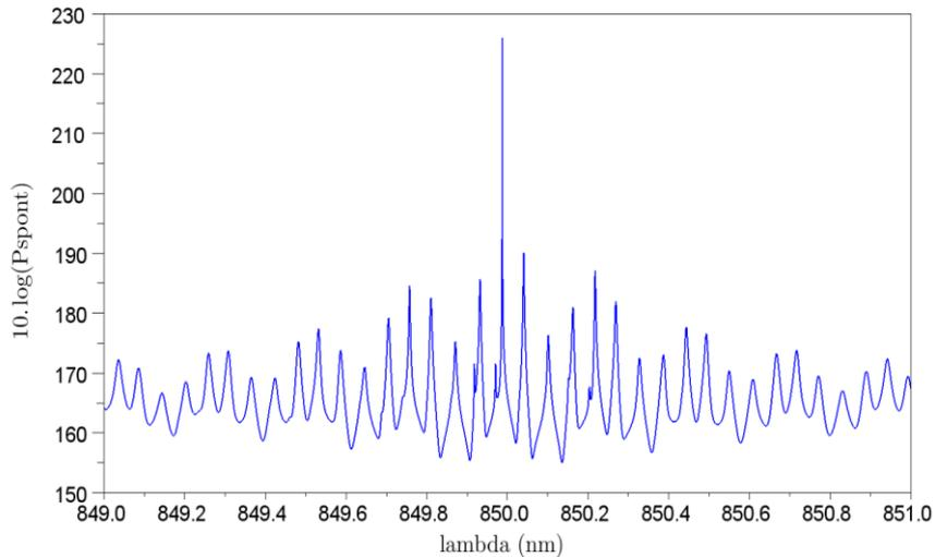
**Figure 2-19: Spectre d'émission spontanée calculé pour un réseau de 0.4 nm de large, un laser de longueur 400  $\mu\text{m}$ , des valeurs de réflectivité de 0.2 pour la facette droite du laser et 0.5 pour le filtre et une cavité externe de 5 mm (design 1)**
