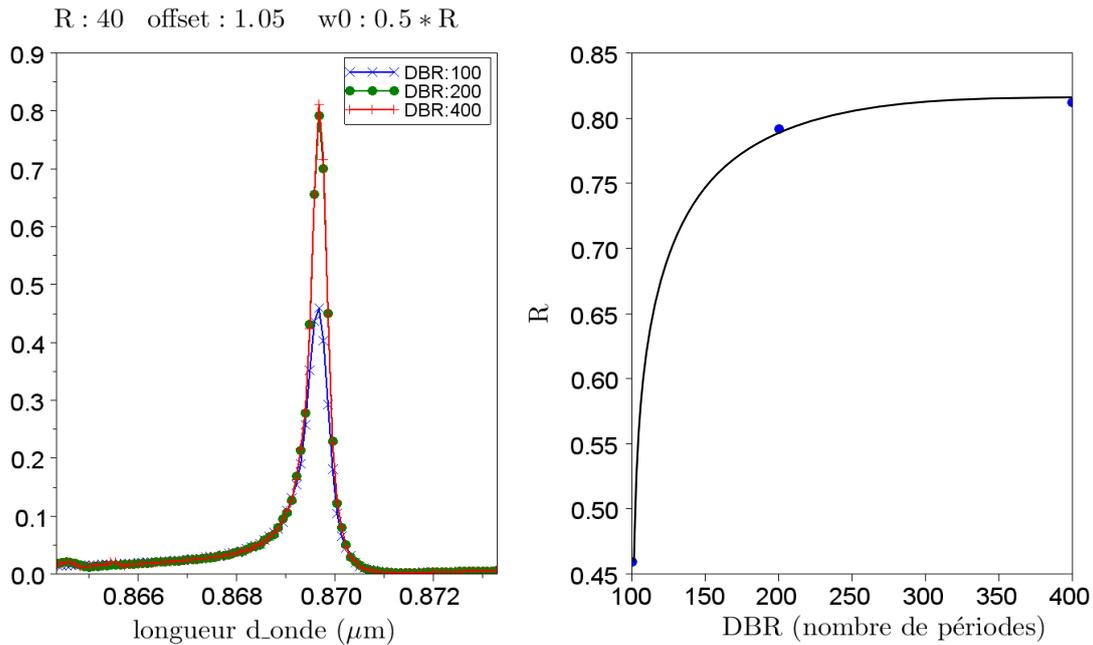
**Figure 3-11 : Evolution de la réflectivité globale de la structure en fonction de la longueur des zones DBR. Gauche : spectres de réflexion, droite : évolution de la réflectivité maximale en fonction de l'extension des DBR. Paramètres de calcul : période du réseau a 535 nm, réseau de 41 périodes a, offset = 1.05a, demi largeur du mode d'excitation de 20 périodes a**
