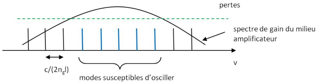
Figure 1-1 : représentation des modes longitudinaux d'une cavité Fabry-Pérot
