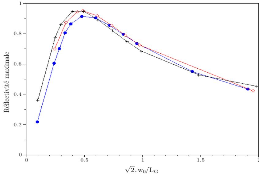
Figure 3-12 : Evolution du maximum de réflectivité avec la taille du mode incident  $\sqrt{2} \cdot w_0$  normalisé par rapport à la taille de la section réseau pour différentes tailles de réseau :  $L_G=21a$  (cercles bleus pleins),  $L_G=41a$  (carrés rouges ouverts),  $L_G=101a$  (croix noires)
