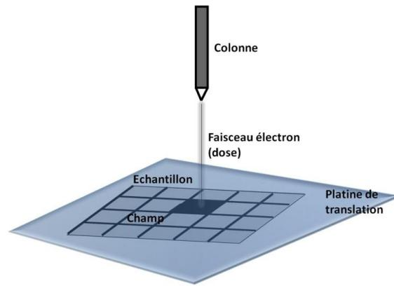
Figure 3-16 : schéma du principe d'écriture par lithographie électronique
