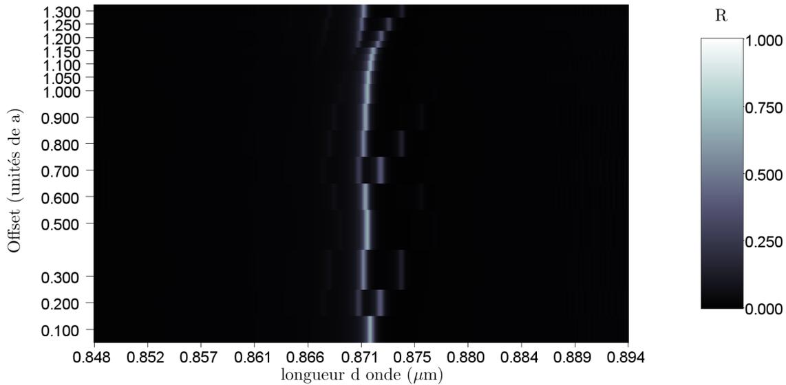
**Figure 3-10 : cartographie 2D de réflexion du filtre en fonction de la longueur d'onde et de l'offset entre les zones réseau et DBR. Paramètres de calcul : réseau de 201 périodes (100  $\mu\text{m}$  de large), DBR de 100 périodes (25  $\mu\text{m}$  de large), demi waist du faisceau d'excitation de 200 périodes ( $\sim 100 \mu\text{m}$  de large).**
