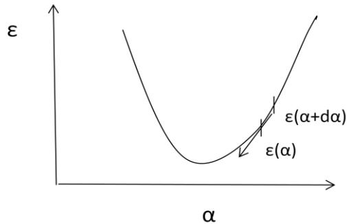
Figure 2-13: Méthode des gradients utilisée pour la minimisation de l'erreur
