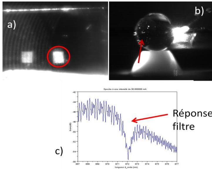
Figure 4-7 : a) : Réglage de la position du réseau par la caméra 1 : faisceau sur réseau (cercle rouge). b) : Réglage de l'inclinaison réseau par la caméra 2 : il faut fait remonter le faisceau réfléchi dans sur la bille (flèche rouge). c) : Spectre obtenu à l'OSA pour un courant injecté sous le seuil lorsque le réseau est correctement réglé.
