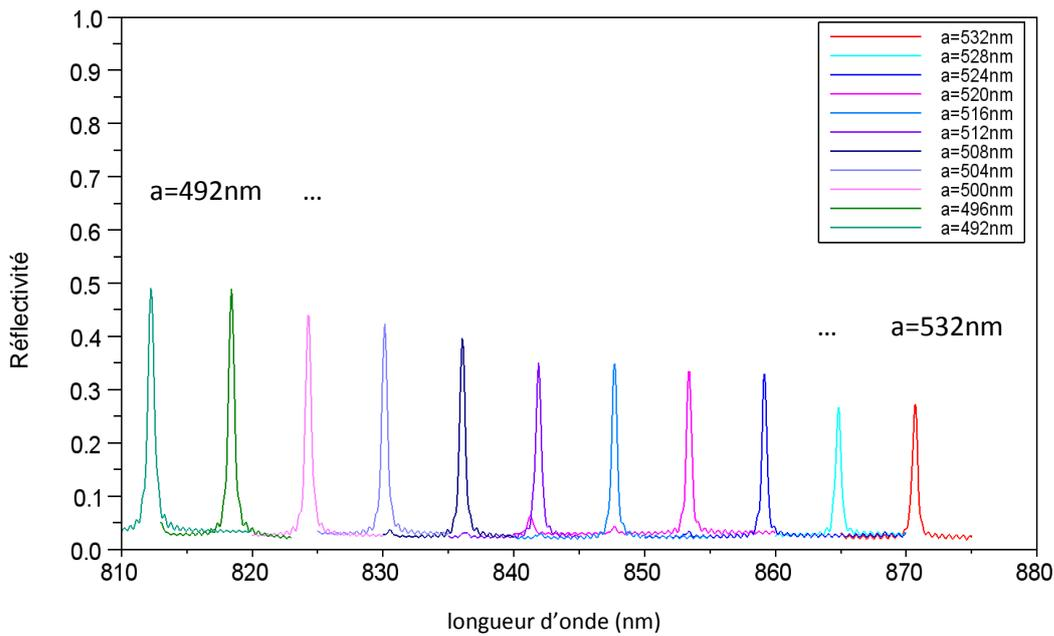
Figure 3-42 : spectres mesurés sur les réseaux moyenns 2D pour des pas compris entre 492 nm et 532 nm (de gauche à droite : de 492 nm à 532 nm)
