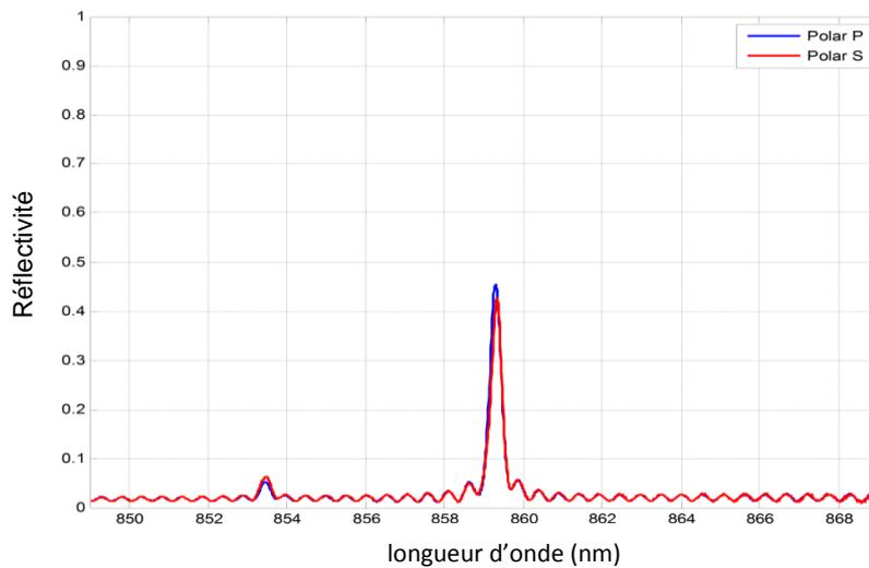
Figure 3-45 : Spectres de réflectivité mesurés pour le réseau 2D de pas 524 nm et de taille moyenne (41a) pour les polarisations s et p avec la lentille de 25 mm
