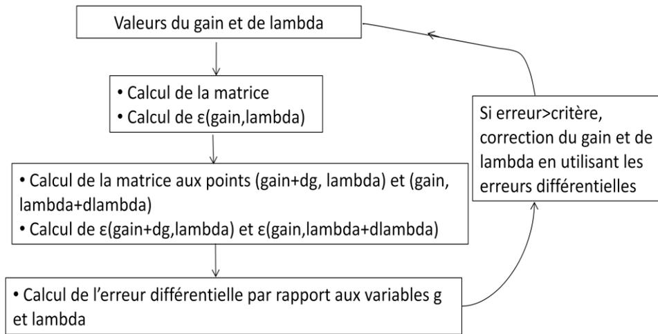
Figure 2-14: Algorithme de calcul du gain au seuil et du mode
