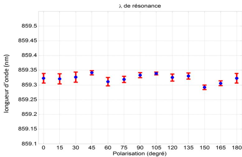
Figure 3-47 : Evolution de la longueur d'onde de résonance en fonction de l'angle de polarisation, avec en rouge la barre d'erreur
