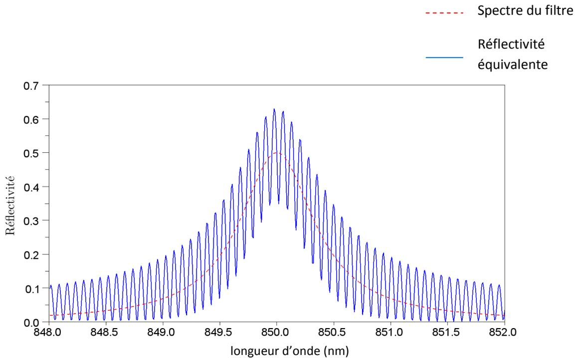
Figure 2-5: Réflectivité équivalente pour un filtre de largeur spectrale 0.8 nm avec une réflectivité maximale de 0.5 et  $r_2=0.2$ , et une cavité externe de 5 mm (courbe continue) et spectre du filtre (courbe en pointillés)
