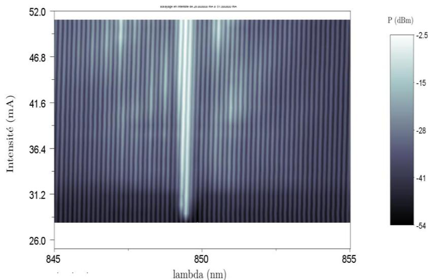
**Figure 4-19 : cartographie du spectre optique d'une diode Thalès sous réinjection d'un réseau résonant pour une cavité externe de 9.5 cm et à T=35°C**
