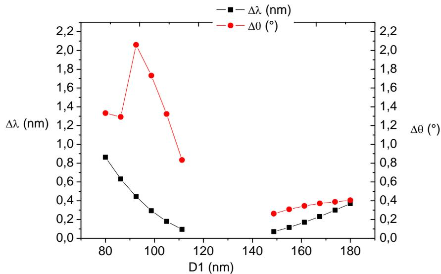
Figure 3-7 : Evolution de la largeur spectrale et de la tolérance angulaire en fonction de la largeur de ligne  $D_1$ . Pour la zone comprise entre 120 nm et 140 nm, nous retrouvons le cas homogène.
