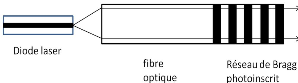
Figure 1-9 : Montage de réinjection par un réseau de Bragg inscrit dans une fibre
