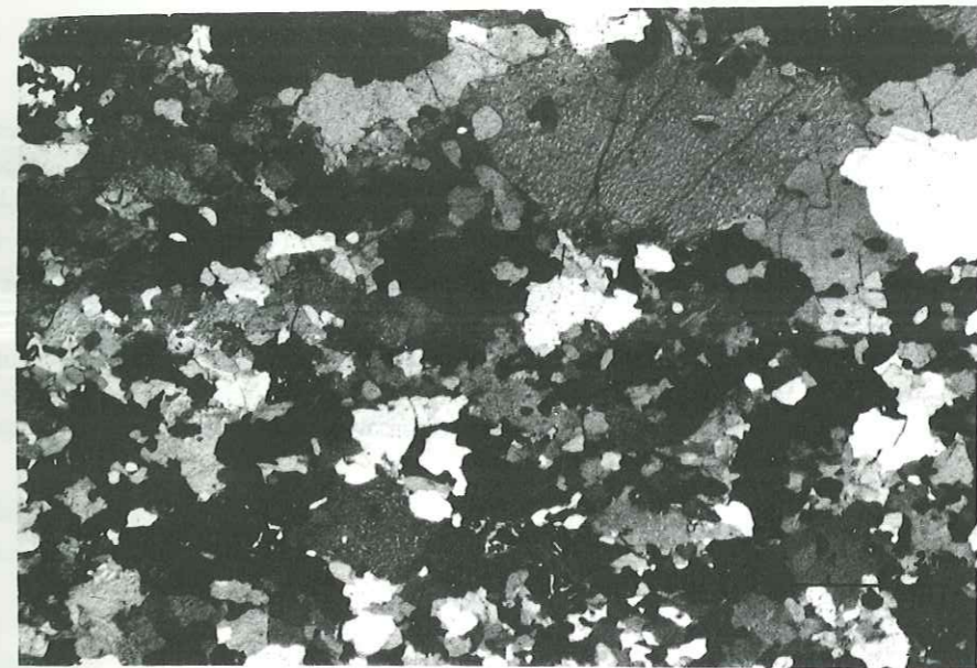
Photo n° 1 - Structure microscopique d'un gneiss vert proche de l'anorthosite à andésine. Lame FB 68-745
