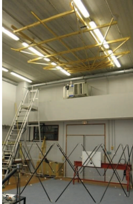
Figure 3-17 : démonstrateur déployé suspendu et fixé à un bâti (au fond)
