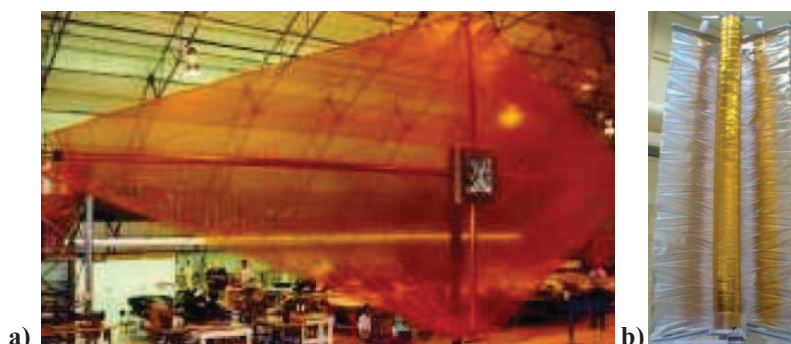
Figure 5-4 : a) voile solaire et b) aile de désorbitation
