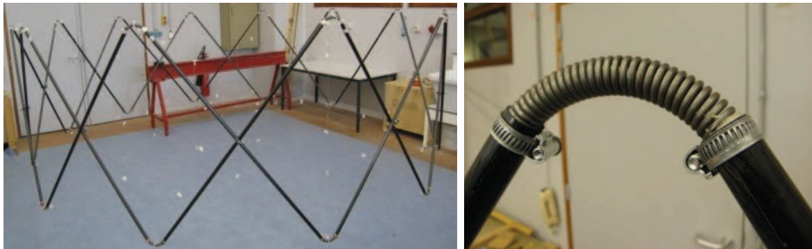
Figure 3-20 : démonstrateur avec articulations en ressort
